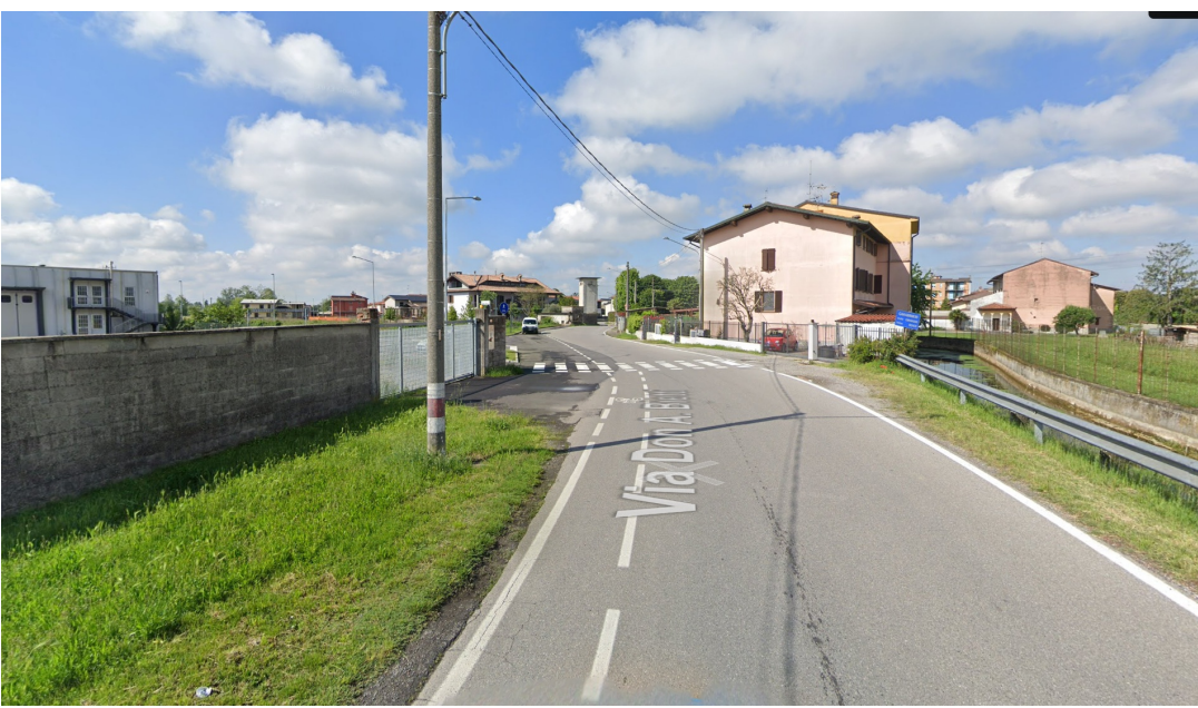
IL PERCORSO DELLA CICLABILE LUNGO VIA BIETTI VIENE REALIZZATO INTERVENENDO SULLE AREE LATERALI ALLA SEDE VIARIA DOVE DISPONIBILE, O IN PROMISCUO CON LA CARREGGIATA STRADALE OVE NON C'E LA DISPONIBILITA' O LA SEZIONE E' INSUFFICIENTE. SUL VUOTO PRESENTE A FIANCO DEL PONTE SULLA ROGIA VERRA' REALIZZATO IL PONTICELLO DELLA CICLABILE E IN SUA PROSSIMITA' E' PREVISTO L'ATTRAVERSAMENTO DELLA PISTA DA UNA PARTE ALL'ALTRA DELLA STRADA. E' PREVISTO L'INTUBAMENTO DELLA RETE DEI PALI DI ILLUMINAZIONE.
