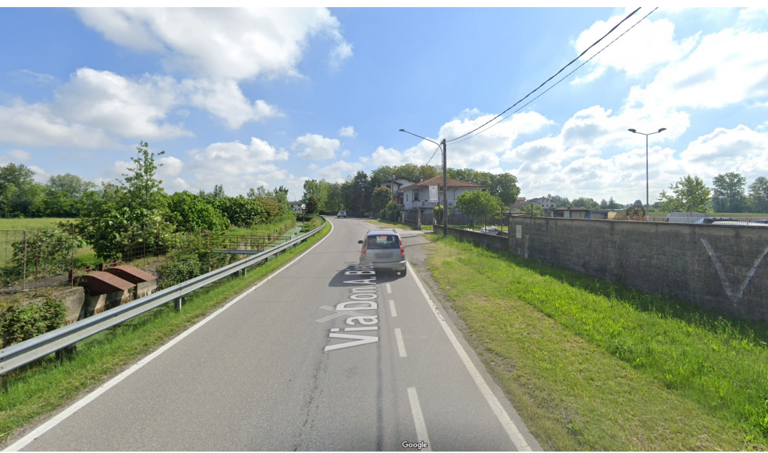
IL PERCORSO DELLA CICLABILE LUNGO VIA BIETTI VIENE REALIZZATO INTERVENENDO SULLE AREE LATERALI ALLA SEDE VIARIA DOVE DISPONIBILE, O IN PROMISCUO CON LA CARREGGIATA STRADALE OVE NON C'E LA DISPONIBILITA' O LA SEZIONE E' INSUFFICIENTE. SUL VUOTO PRESENTE A FIANCO DEL PONTE SULLA ROGIA VERRA' REALIZZATO IL PONTICELLO DELLA CICLABILE E IN SUA PROSSIMITA' E' PREVISTO L'ATTRAVERSAMENTO DELLA PISTA DA UNA PARTE ALL'ALTRA DELLA STRADA. E' PREVISTO L'INTUBAMENTO DELLA RETE DEI PALI DI ILLUMINAZIONE.
